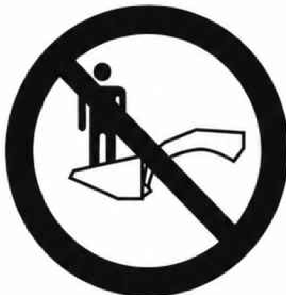
Figure 3-16 Ingen stående på skovlen
